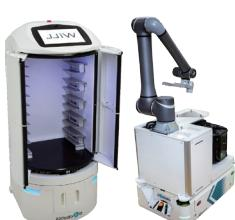
マップデータを元に走行を行い、マニピュレータが人の代わりに作業を行います。ロボットシステムインテグレーターだけでなく、自社オリジナル搬送ロボットも開発。
